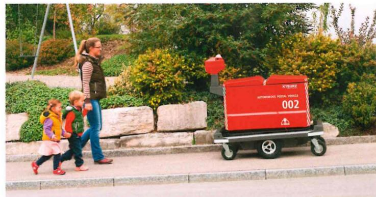
Der autonome eTrolley fährt mit maximal 6 km/h bis zu 40 km weit. Bei einem Leergewicht von 90 kg transportiert er bis zu 120 kg.
