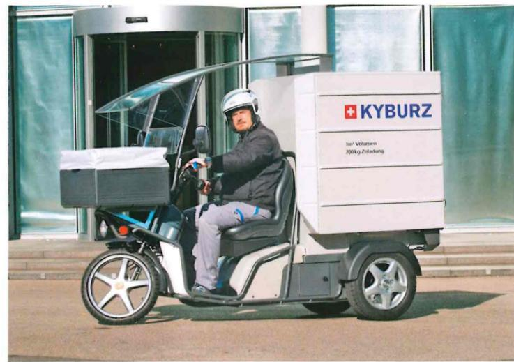
Der Kyburz DXCargo ist mit Lithium-Batterien 240 Ah und einem eingebauten Ladegerät ausgerüstet, mit dem der Akku in acht Stunden komplett geladen werden kann.
